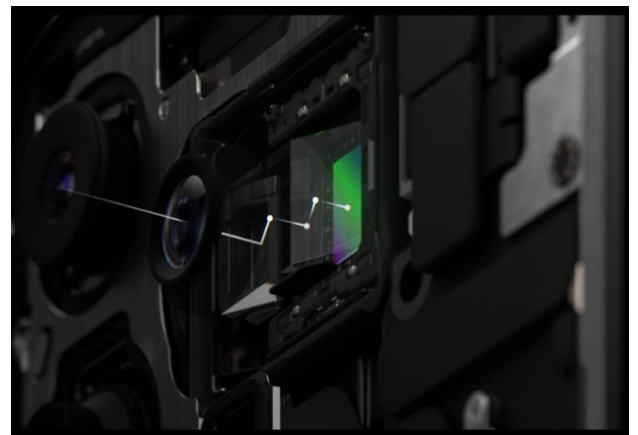
图 21：通过四次反射在短距中实现更长的光路
