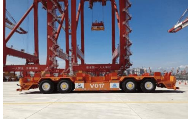
图 12：公司与广州港、振华重工共同研制的北斗导航无人驾驶智能导引车
